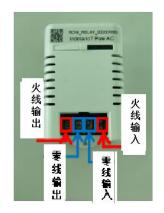
测量模块内无地线接口,设备如需连接地线可直接绕过模块连接地线, 方式如图;
